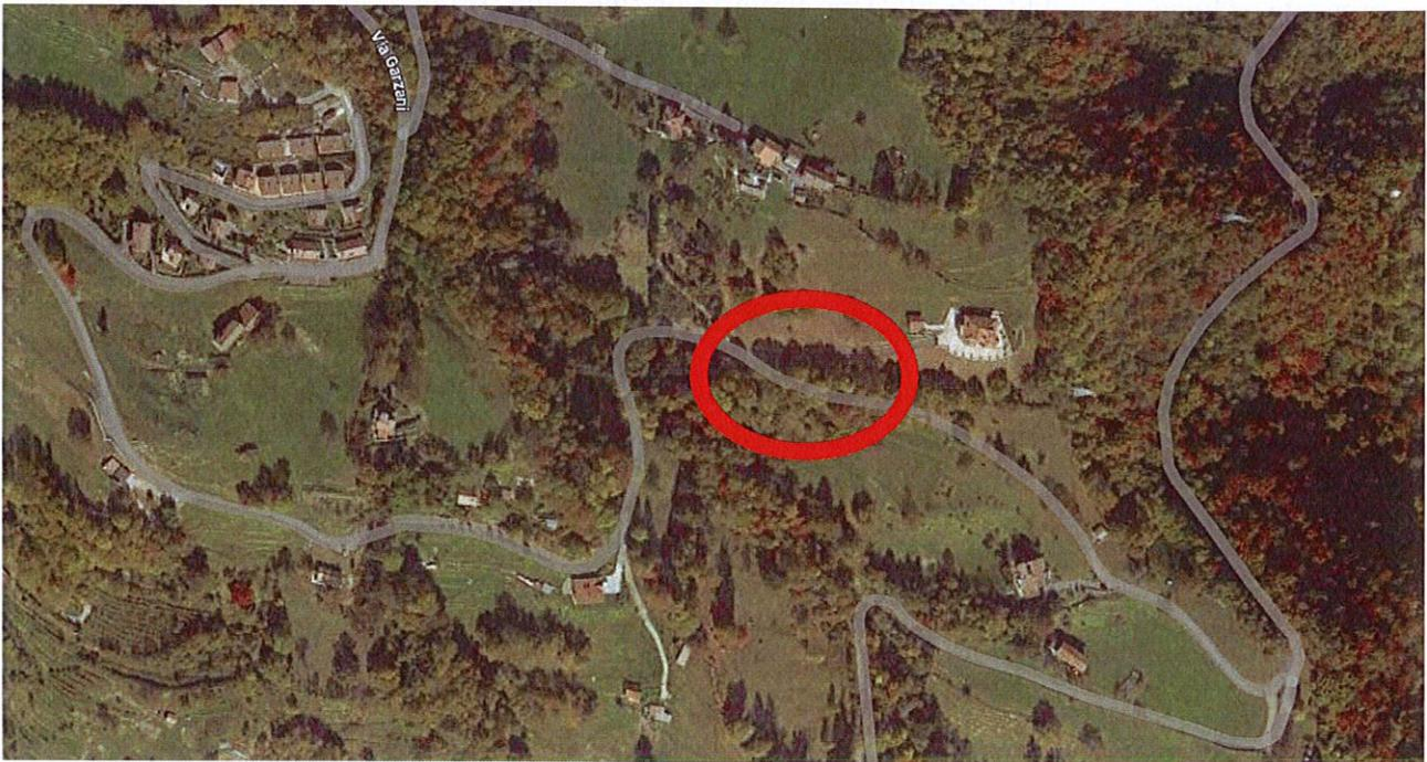
Considerato che lungo la strada in questione è stato rilevato un cedimento della sezione stradale verso valle e i lavori prevedono la demolizione e la rimozione della sede stradale esistente, della massicciata, lo scavo e la costruzione della scogliera;
